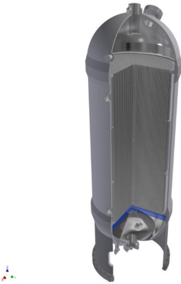
Figur 10. Illustration av reaktor för framställning av e-metanol ur vätgas och koldioxid. Illustration: Haldor Topsoe.
